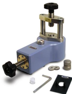
ミニ油圧プレスは最大2トンの荷重が可能で、透明性の高いクリアなKBr錠剤をどなたでも簡単に作成することが可能です。荷重圧力計の内蔵で再現性の良い錠剤作成ができ、定量性を高めることができます。試料単体での成型も可能で赤外透過測定以外の用途にもご利用頂けます。ミニ油圧プレスは小型、軽量ですので、使いたい時に棚などから取り出して作業することができます。
