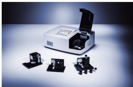
Raman5000シリーズは非常にコンパクトなサイズ (25 × 30 × 15 cm) のラマン分光計です。532 nm、785 nm、1064 nmからサンプルに最適な1波長または2波長を1筐体に搭載。ディスプレイからタッチペンによる直感的な操作を行う事でどなたでも手軽に実験、解析を実現します。溶液、個体、錠剤と各種サンプルに対応したサンプルホルダーを使用する事でサンプル調整が不要です。
