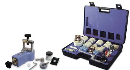
FT-IR スタータキットのベーシックソリッドバック (GS01150) はミニプレスベーシックキット・KBr 粉末・乳鉢・乳棒がセットになっており、固体試料の赤外透過測定に必要なものがすべて含まれます。
