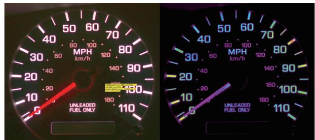
車載パネルの測定結果左: 実色、右: 輝度疑似カラー
