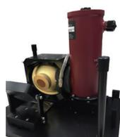
FT-IR試料室に取り付け可能な高性能積分球アクセサリで、全半球反射率・透過率の測定に最適です。光散乱するサンプルを容易に測定することができます。
