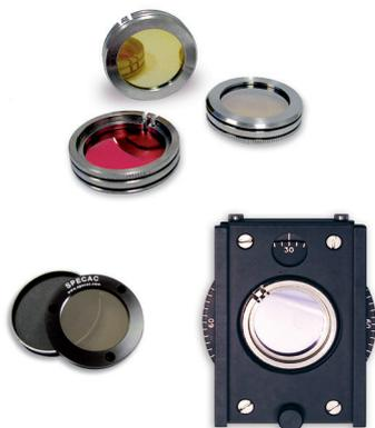
ホログラフィック/フォトリソグラフィ技法を用いた偏光子で、平行なアルミニウムのアレーが基板上に最高1mmあたり4000ライン印刷されています。基板の種類は測定領域、目的に応じて選択できます。偏光子は金属製のサポートリングに保持されており、目盛り付の回転ホルダーがオプションで用意されています。
