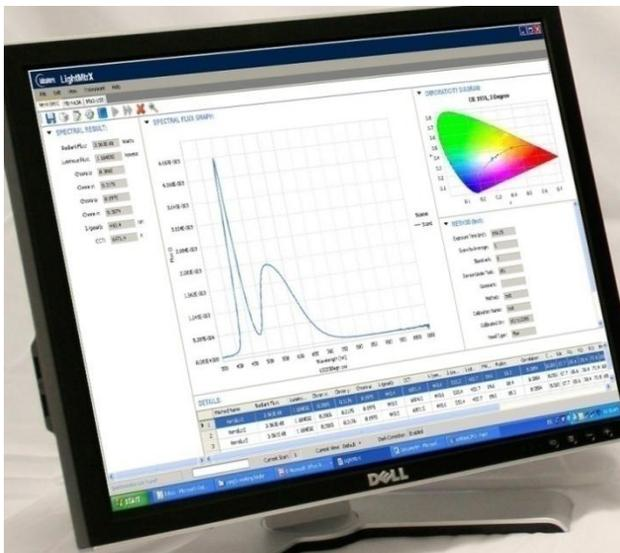
※付属の専用ソフトウェア『MtrX-SPEC』によって、システム校正からデータの保存までコントロールできます。保存されたデータはエクセルファイルへの変換が行えるので、レポート作成も簡単に実行できます。
