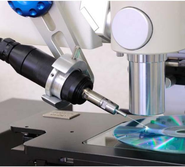
いままでは難しくてあきらめていたような、樹脂などに埋没した異物の切削を短時間でどなたにでも行なえるように開発された、切削アタッチメントです。
