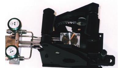
触媒反応測定用チャンバー CRIC と組み合わせた様子
