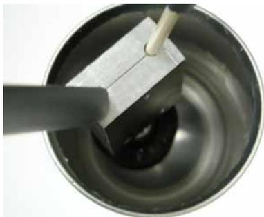
Fig.6 缶の内部へ挿入し缶底部を測定
