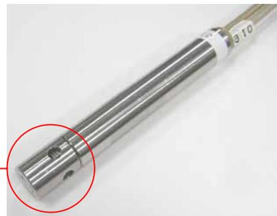
Fig.2 反射測定プローブ
