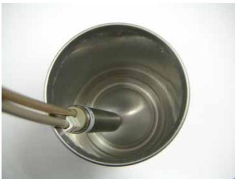
Fig.9 缶の内部へ挿入し缶底部を測定
