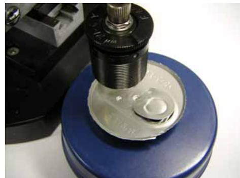
Fig.7 缶上部を切り取り、その裏面を測定
