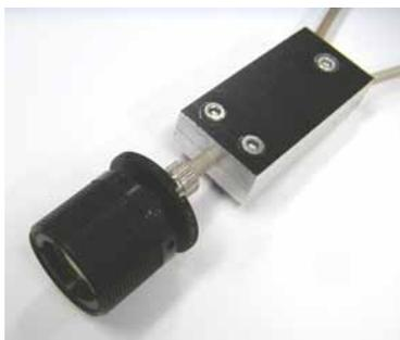
Fig.3 レンズ付反射測定プローブ(F=10mm)
