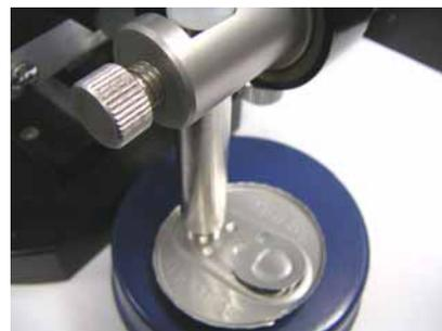
Fig.10 缶上部を切り取り、その裏面を測定
